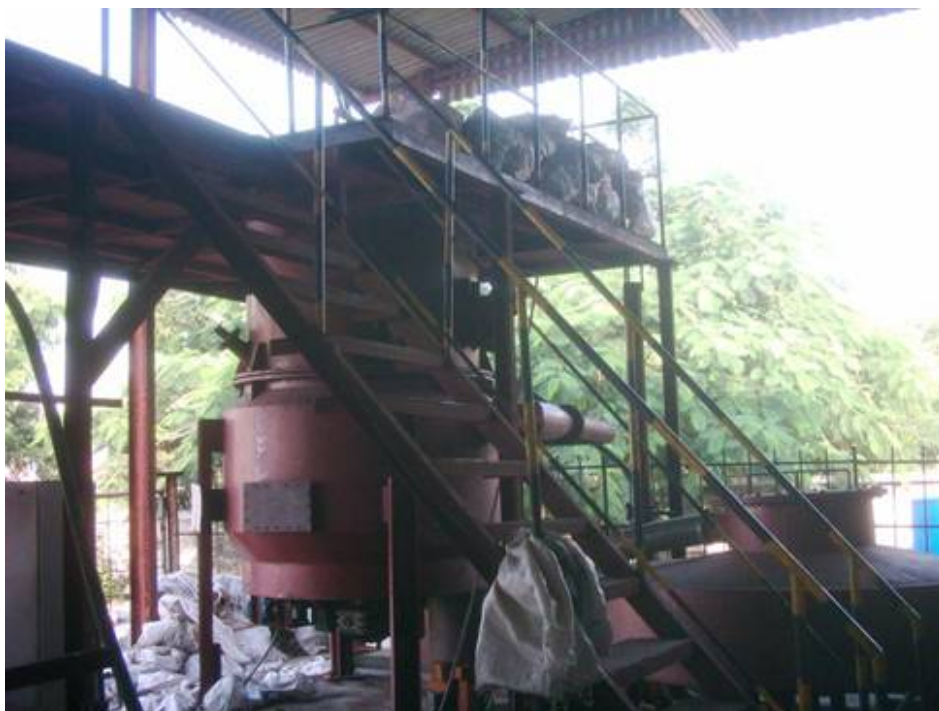
Slika 3. Sušara keramike sa rasplinjačem biomase, Indija.
